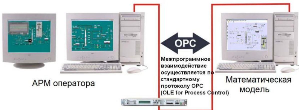
Рис. 3. Механизм взаимодействия АРМ оператора и математической модели технологического объекта.
